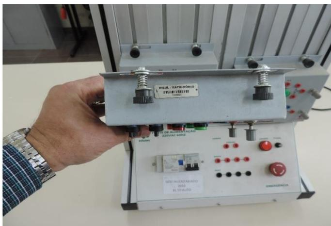
Item n. 108650 – bancada didática modular, estrutura em alumínio anodizado 30 x 60mm. Dimensões: 735x505x300mm, acabamento em perfil pvc preto, pés de borracha, alça para transporte. 01 módulo fonte monofásico, 220vca. 01 módulo clp com 24 entradas digitais. Placa patrimonial afixada em parte móvel do bem (módulo).
