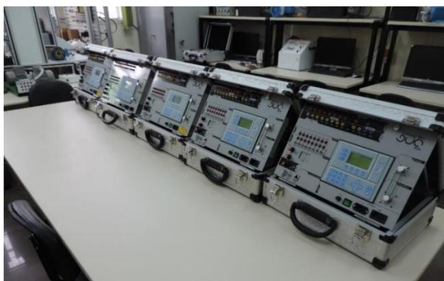
Kit didático portátil para treinamento de CLP – 8 entradas e 8 saídas digitais, 2 entradas e 1 saída analógica, potenciômetro de simulação das entradas analógicas. Marca: Altus
