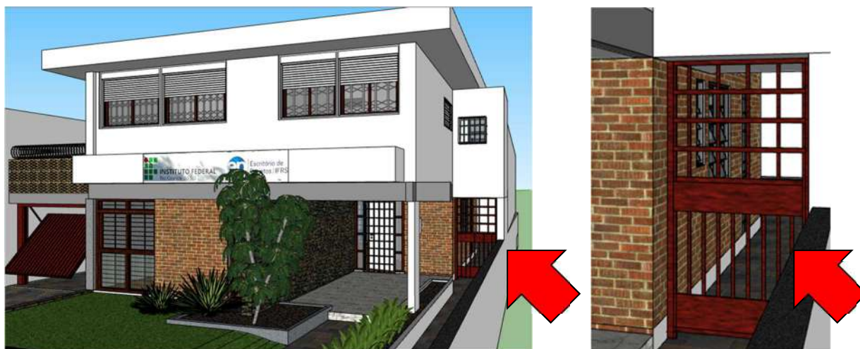
Figura 15: Localização da porta P10 existente a ser reforçada com duas linhas de barras horizontais, com trava no chão e cadeado.
