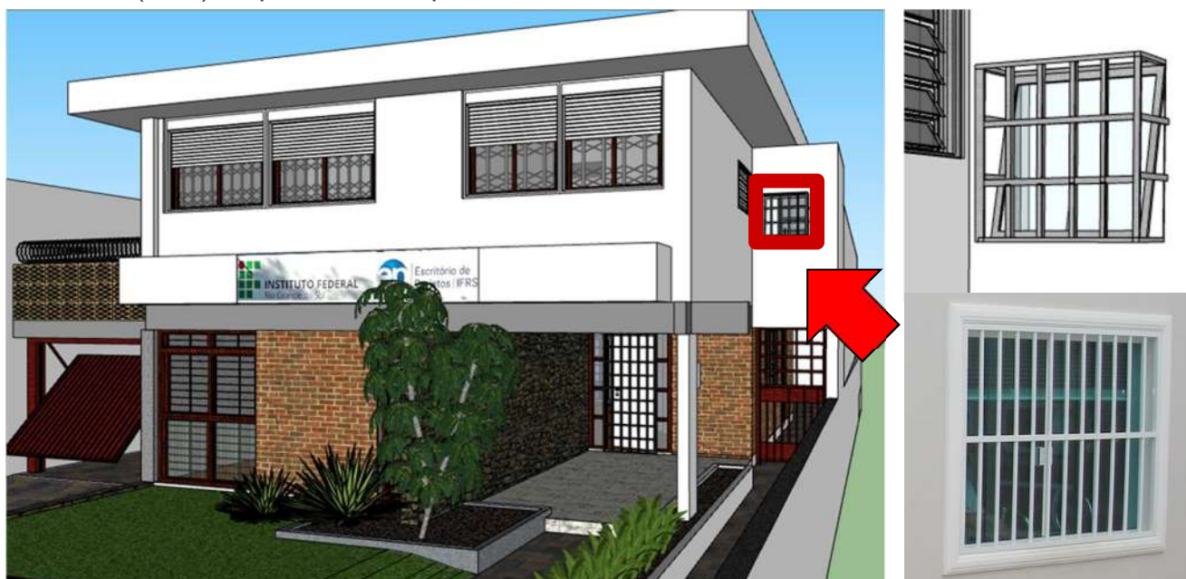
Figura 10: Localização da grade fixa e exemplo de modelo de grade vertical para janela.
