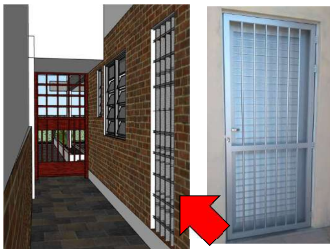
Figura 02: À esquerda: A porta existente P4 (localizada na cozinha) deverá receber a instalação de um portão-gradil de uma folha de abrir por fora da casa, com chave tetra e trava manual no chão. À direita: Imagem referência de portão-gradil de abrir.
