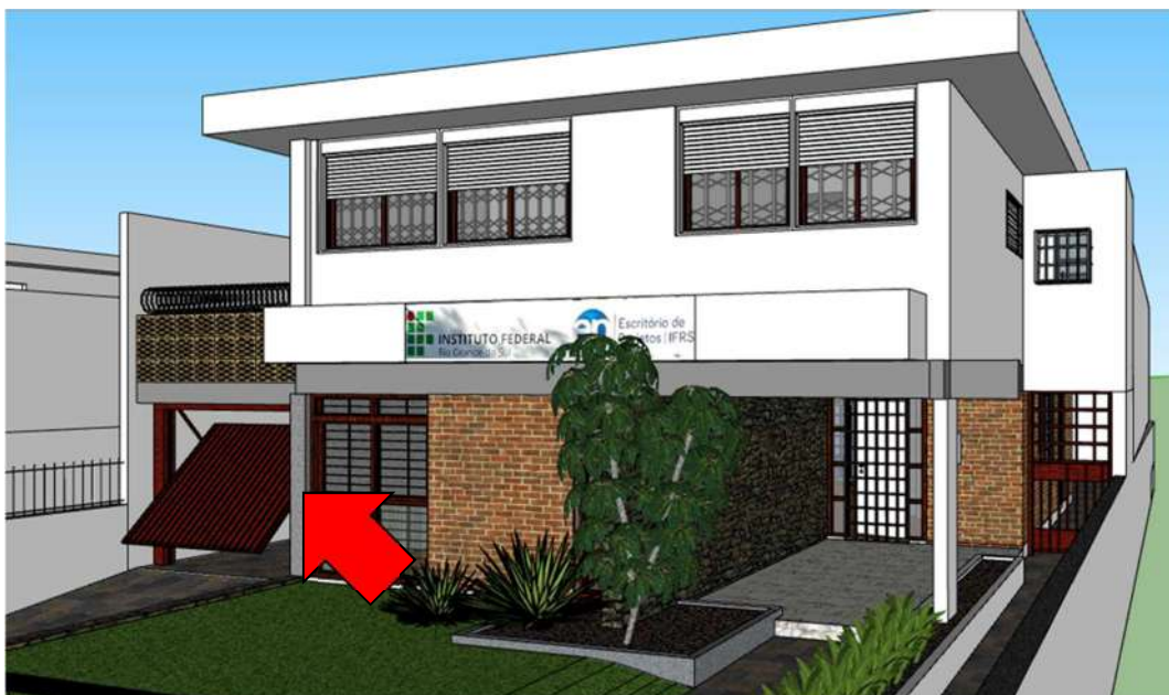
Figura 08: Localização do portão P9 a ser feita manutenção por serralheiro e instalado trava no piso e cadeado.
