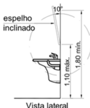
Colocação de espelho em sanitário para PNE
